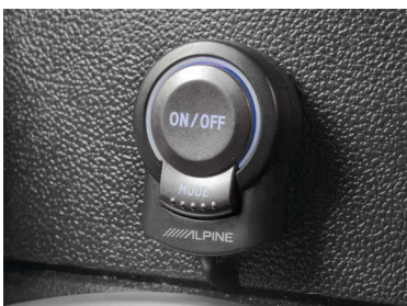
Это не кнопка запуска двигателя (хотя похоже). Это — управление видеокамерой
