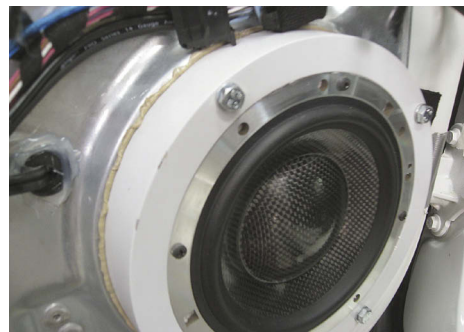
Мидбас Elate LE (картон взамен полипропилена) смонтирован на мощном опорном кольце
