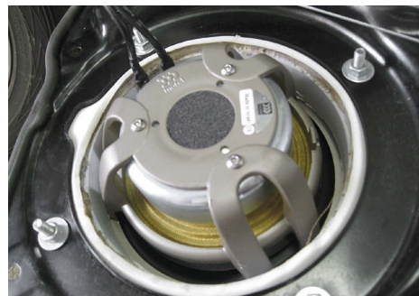
Двери у этой машины разборные, отсюда — доступ к тылам динамика при монтаже
