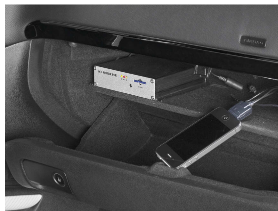
В перчаточном ящике поместился основной блок «компонентного» видеорегастратора и интерфейс для «i-десерта»
