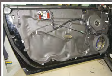
Устройство двери: подиум для «девятки» и переходной фланец для купольника
