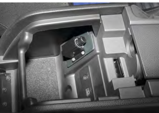
Дистанционный регулятор басового моноблока в укромном месте
