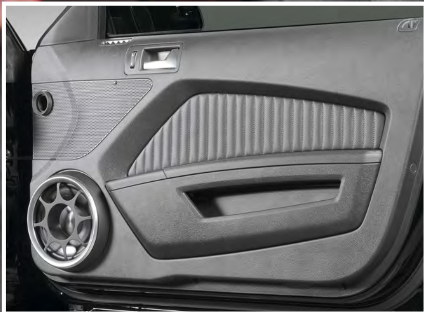
Пропорции дверей скрадывают фундаментальные размеры НЧ-драйвера. Среднечастотник укрывает штатная сетка под «лопушок» калибра 5 x 7, столь любимого компанией Ford
