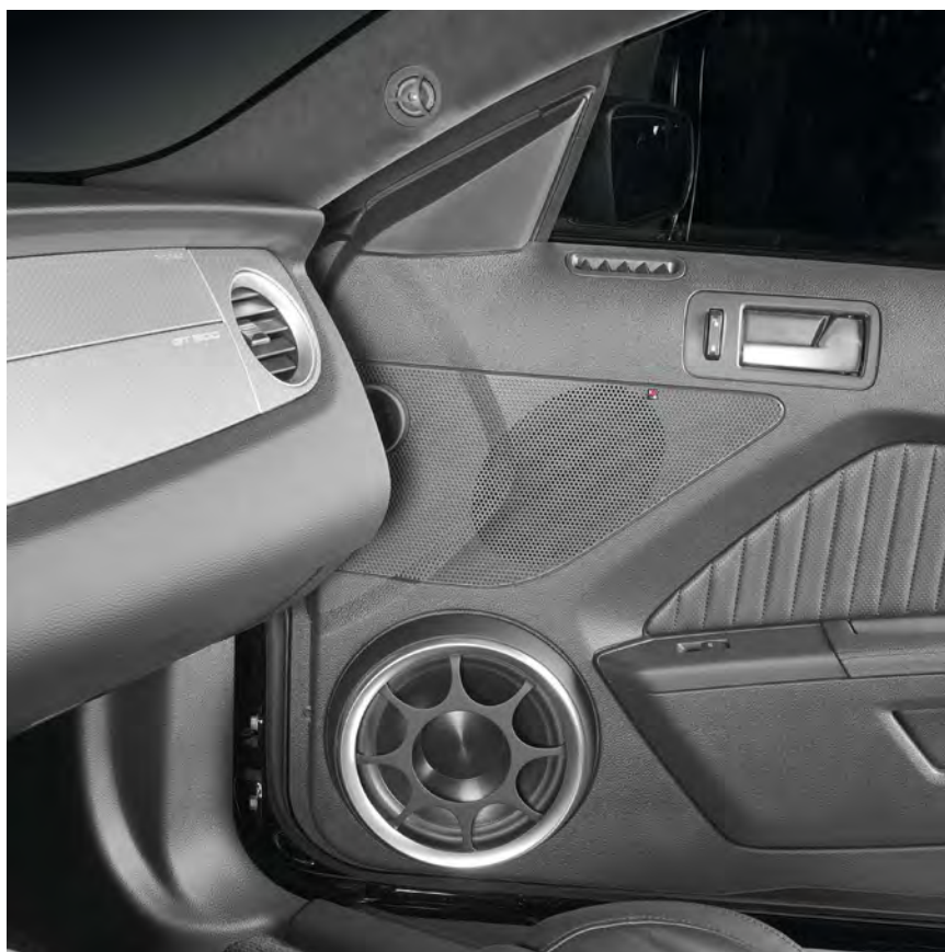
Установка пищалок в скошенной трубе несколько роняет конструкцию с незаслуженно забытыми излучателями Карлсона
