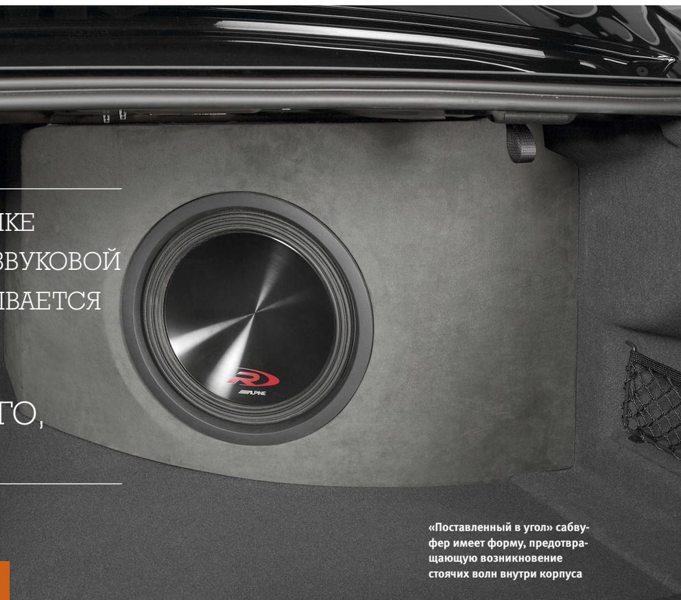
«Поставленный в угол» сабвуфер имеет форму, предотвращающую возникновение стоячих волн внутри корпуса
